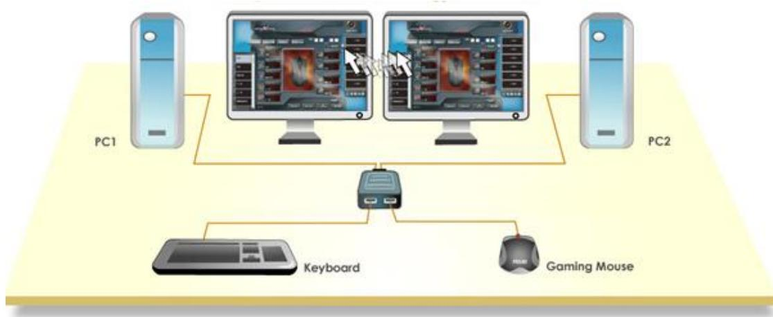
Le commutateur KM permet une configuration multi-plateformes entre des ordinateurs de bureau ou portables fonctionnans sous différents OS. Il peut également être utilisé avec des PC tablette sour Windows.
