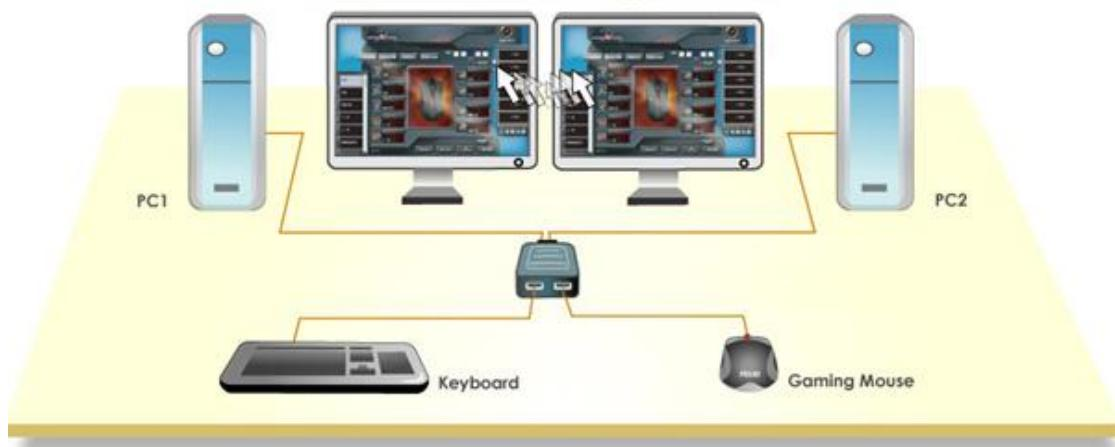
Il KM Switch consente l'installazione su PC operanti con diversi sistemi operativi. Può essere utilizzato anche con Tablet PC Windows.
